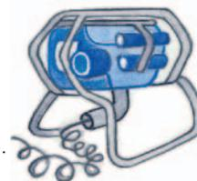
Los **flotadores** sostienen los aparatos de medida a una profundidad determinada.
